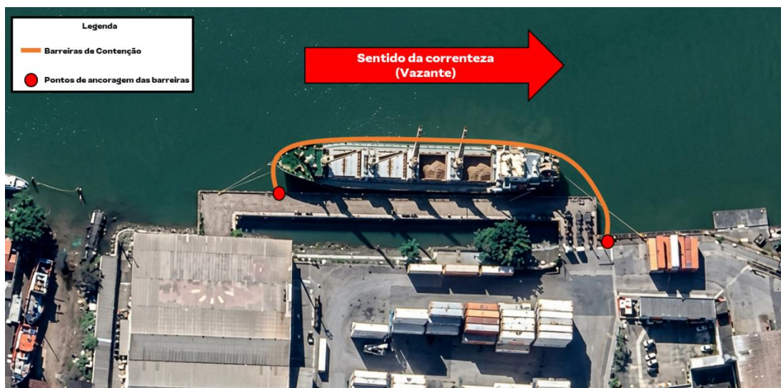
Figura 1 – Formação de cerco preventivo, considerando maré vazante
